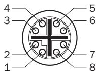
Gigabit-Ethernet: M12 8-polig, X-codiert
