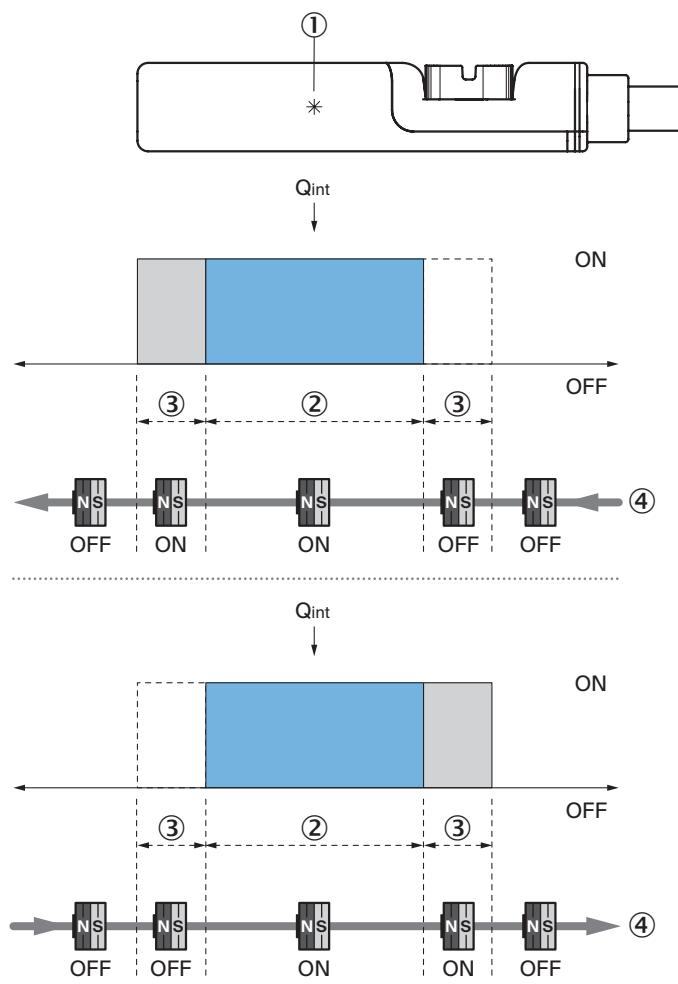
Hinweis: Sensorgehäuse kann abweichen; Darstellung entspricht Ausgangsfunktion „Schließer“; Überfahrweg = Schaltpunktbreite + Hysterese
