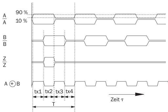
Bei konstanter Drehzahl, mit Blick auf die Eingangswelle und Drehung im Uhrzeigersinn.
